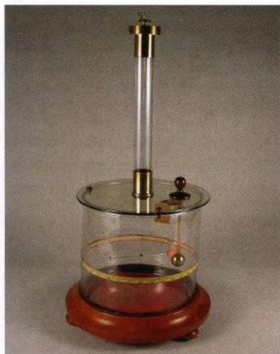
Balance électrostatique signée Pixii Père et fils du lycée Bertran-de-Born de Périgueux.
